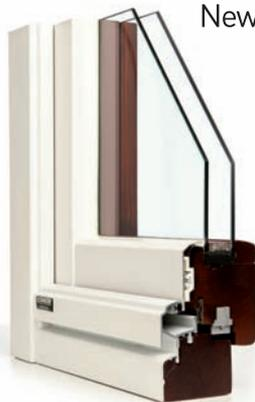
Serie **New Focus** in legno-alluminio: Sezione anta 68x79 mm; sez. telaio 64x70; vetrocamera 28 mm ; doppia guarnizione; zoccolatura doppia su balcone con soglietta h = 49 mm; ferramenta cerniere con anube da 16 mm.
