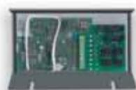
Consente la ricezione del segnale radio inviato dal radiocomando ed è la base di collegamento per tutti gli accessori esterni, quali display, sensore e pulsante a sfioramento. Viene fornito di serie in tutte le Automazioni, tranne la A.
