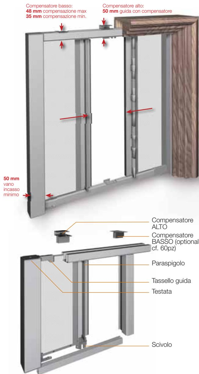
**ASIA** è una zanzariera da incasso a scorrimento laterale realizzata con rete in fibra di vetro, chiusura magnetica, molto facile da movimentare: per aprire e chiudere questo modello di zanzariera infatti non è necessario chinarsi. La versione a due battenti consente inoltre di bloccare una delle due ante.
