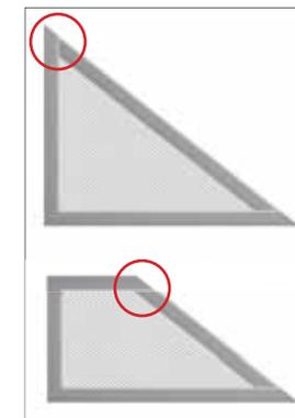
Nei telai fissi con forma irregolare, ove indicato nel disegno o non è possibile l'utilizzo della squadretta, la giunzione dei profili in alluminio avviene mediante ribattini.
